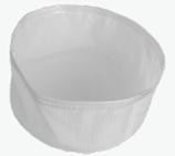
✓ **filtro** opzionale a cartuccia in **poliestere idro-oleo repellente con membrana PTFE** esterna da 2,7m<sup>2</sup> di superficie filtrante (classe H13)
